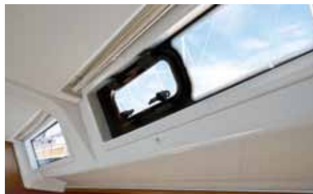
FENSTER MIT MANKO Die Luken sind größer und heller als früher, aber die Querbelüftung fällt gering aus
