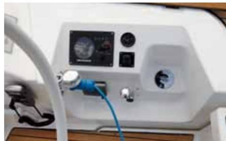
BEDIENUNG MIT SCHUTZ Unter einer wegklappbaren Sitzfläche liegen Gashebel, Motorpaneel und Landanschluss
