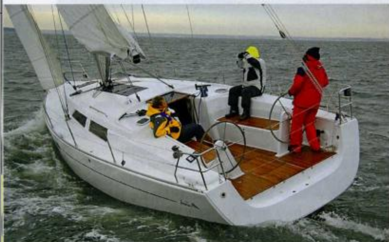
Bis auf die Bedienung der Achterstagtalje, ist das riesige Cockpit frei von weiteren Leinen.
