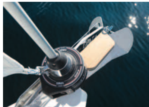
Multitool. Der Stevenbeschlag ist Trittstufe, Buggspriet und Ankerhalterung in einem
