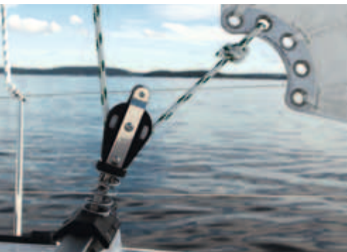
Typisch. Der Selbstwender ist der Standard, Alternativen sind lieferbar
