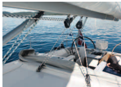
Simpel. Die Großschot läuft nur über zwei Punkte an Deck. Einen Traveller gibt es nicht
