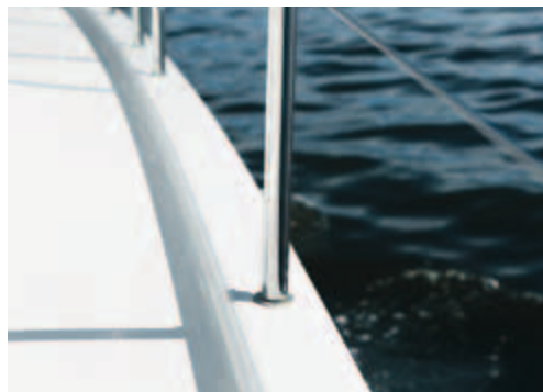
Stärker. Die Fußhülsen der Relingstützen sind jetzt in den Decksflansch eingegossen
