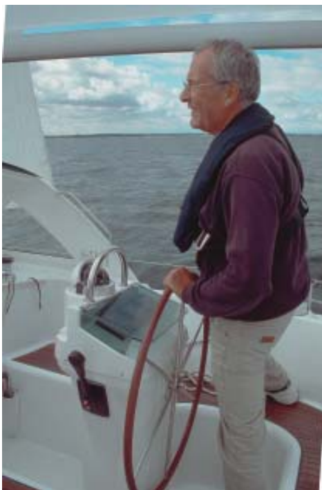
Die Instrumentenabdeckung ist scharfkantig und reicht zu nahe an das Rad.
