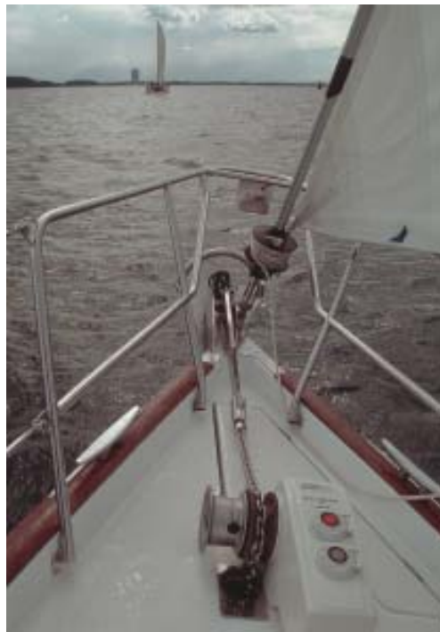
Eine Ankerwinch gehört zur Standardausrüstung.
