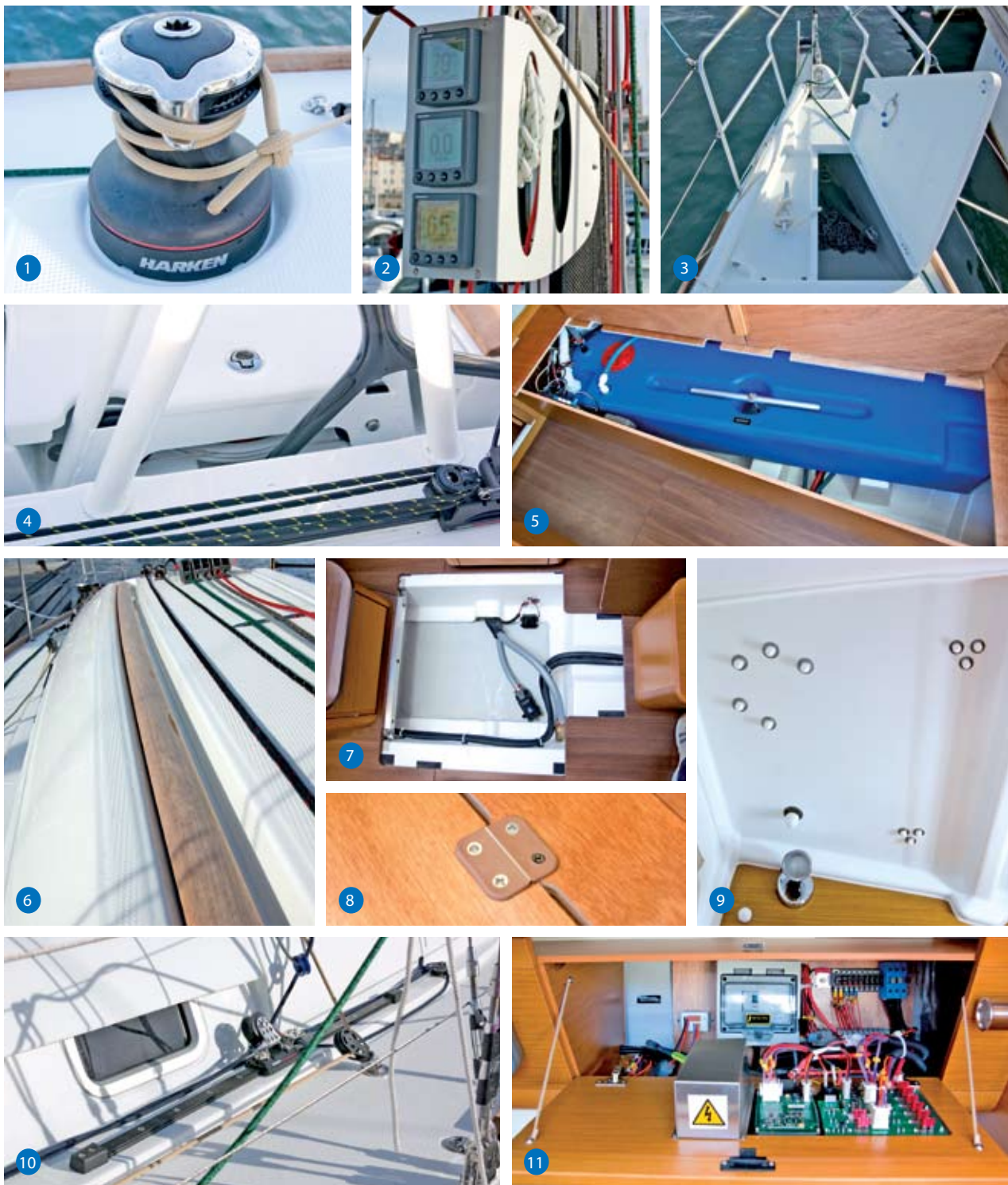
Details: 1. hochwertige Beslagsausstattung; 2. Instrumentenmontage am Mast; 3. selbstflenzender Ankerkasten; 4. gut erreichbarer Ruderquadrant; 5. Wassertanks unter den Salonbänken; 6. versenkte Teak-Handläufe auf dem Kajütdach; 7. Bilgensumpf; 8. einfache Kunststoffscharniere an den Bankdeckeln; 9. sichtbare, aber dafür gut zugängliche Verschraubung der Decksbeschläge; 10. leinenverstellbare Holepunkte mit Kugelgelagerten Schlitten; 11. ordentliche Elektroinstallationen.
