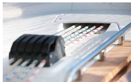
Alle Fallen und Strecker werden sauber ins Cockpit geführt (Bild CR 40) – für die einfache und zentrale Bedienung
