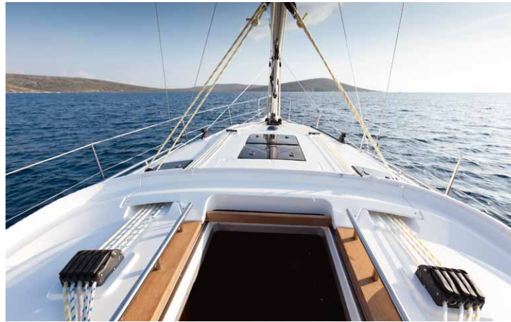
BAVARIA Doppel-Großschotsystem für ein genaues Trimmen ohne Traveller und sicheres Halsen
