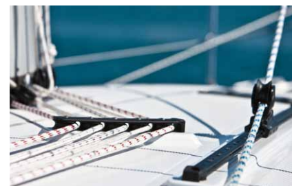
Die Genuaschienen auf dem Decksaufbau sorgen sowohl für ein aufgeräumtes Seitendeck als auch für hervorragende Am-Wind-Eigenschaften
