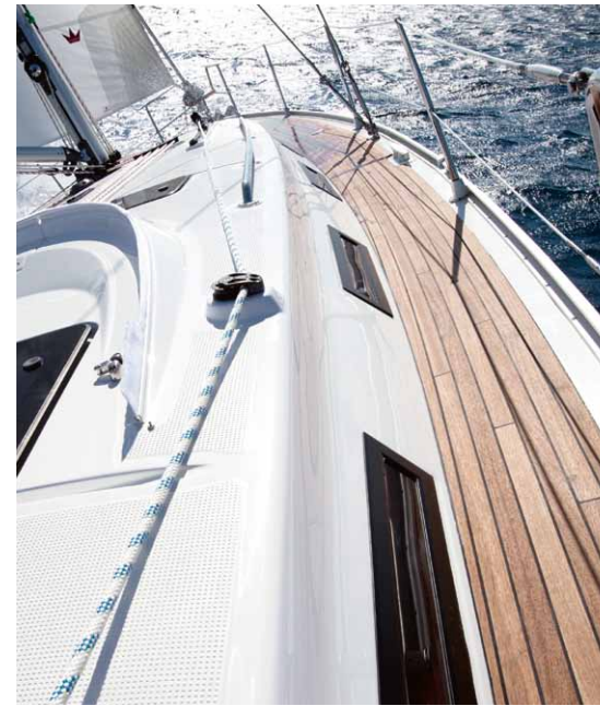
Modernes 9/10-Rigg mit breiten Salingen und außen liegenden Wantenpüttingen ermöglichen hervorragende Am-Wind-Eigenschaften, optimale Kräfteinleitung in die Rumpfstruktur und ein breites Laufdeck
