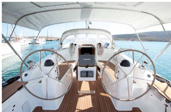
Die Doppelradsteuerung (CR 55, 50, 45 und 40): viel Schutz durch hohe Sprayhoods* und Voll-Biminis* gegen Wind und Wetter
