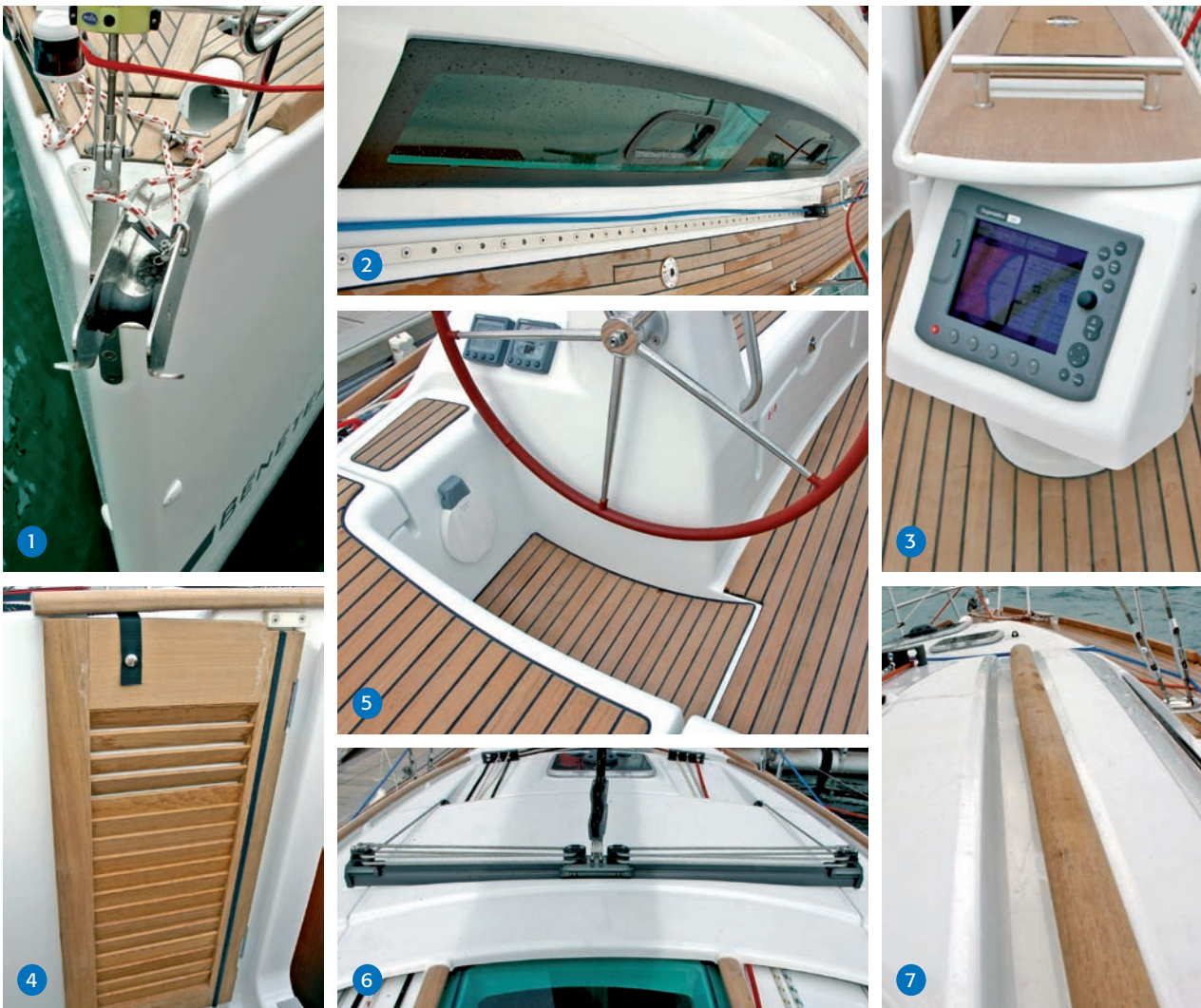
Details an Deck: 1. Edelstahl-Bugbeschlag mit Ankerrolle und Kettenführung; 2. in die großen Seitenscheiben sind zu öffnende Fenster eingelassen; 3. schwenkbarer Instrumententräger am Cockpittisch, 4. die Flügeltüren vor dem Niedergang kennt man bereits von der Cyclades, 5. abgerundete Flächen im Cockpitboden sorgen für sicheren Stand, 6. großzügiger Traveller mit guter Untersetzung; 7. ebenso formschöne wie solide Handläufe am Kajütdach
