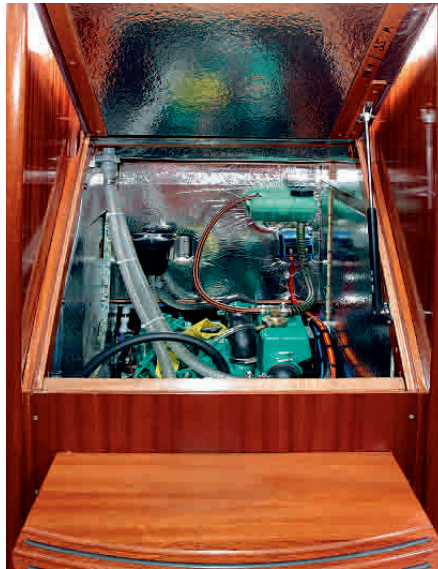
Zu eng: Der Motorraum ist vom Salon aus nur durch eine obere Klappe zugänglich
