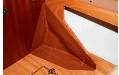
Ungewöhnlich: Die weit nach außen verlegte Sitz-Sektion wurde von innen fixiert
