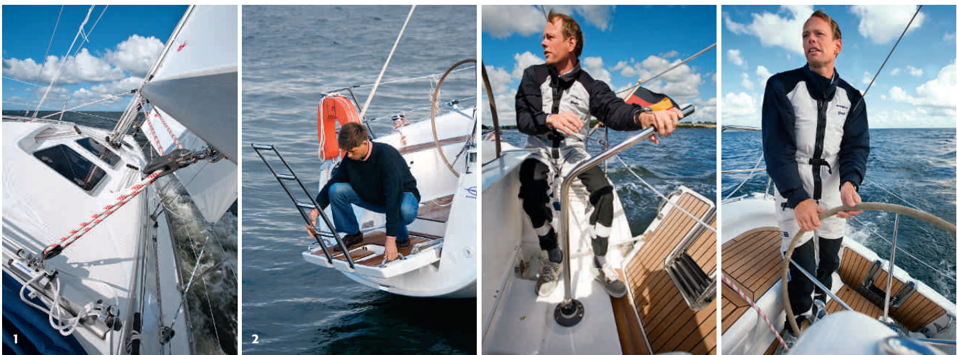
1. Das neue Großschotsystem verfügt über einen Traveller und stellt damit eine echte Verbesserung dar 2. Eher als Verkaufsgag ist die Heckklappe anzusehen. Hier wäre eine Talje zweckmäßiger als E-Motoren. Auch bietet sie keinen Sitzplatz mehr 3. Die Notpinne zwingt zum Umdenken, der Hebel ist kurz, aber für den Notfall reicht's 4. Der Rudergänger hat einen schlechten Stand an Bord. Die Dimensionen rund ums Rad könnten besser sein. Außerdem fehlen Fußstützen – die sind aber leicht nachzurüsten
